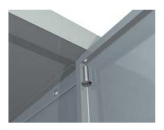
13. Для установки на дверь замка снять гайку и шайбу крепления корпуса. Вставить корпус замка в соответствующее отверстие двери и зафиксировать его с помощью гайки с шайбой.
