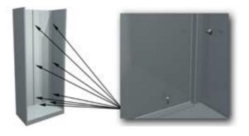
7. Установить полки. Установку рекомендуется начинать с нижней полки. Для установки полки следует завести ее в пространство между боковинами, повернуть вокруг продольной оси и завести таким образом, чтобы выступающий кронштейн оказался в прорези правой боковой стенки, а боковые отбортовки полки попали под фиксирующие полосы на боковых стенках. После этого опустить полку вниз до защелкивания замков фиксирующих полос в отверстиях полки.
