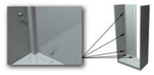
6. Установить правую заднюю стенку, соединив ее с левой задней стенкой с помощью трех саморезов, с правой боковой стенкой — с помощью трех саморезов и с дном — с помощью двух саморезов.
