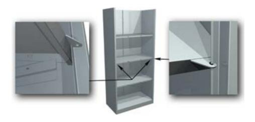
8. Установить крышу. При установке крыши боковые и задние стенки должны располагаться между внутренними боковыми поверхностями крыши и угловыми профилями. Крышу опустить вниз до защелкивания замков боковых стенок в отверстиях угловых профилей крыши.
