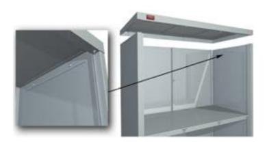
9. Установить перегородки. Установку перегородок рекомендуется начинать с самой верхней. Верхние перегородки отличаются от нижних наличием на верхней отбортовке двух прямоугольных отверстий. Верхнюю перегородку завести верхней отбортовкой под фиксирующую полосу крыши и задвинуть до защелкивания замков. Затем соединить верхнюю перегородку с нижней с помощью двух винтов М5х10 с гайками (сквозь отверстия в полке). Самую нижнюю перегородку соединить с дном с помощью двух саморезов.
