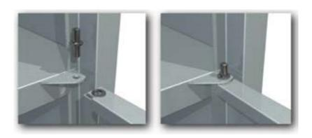
12. Самую верхнюю дверь надеть нижним отверстием на ось и, совместив верхнее отверстие с отверстием в крыше, зафиксировать дверь с помощью винта M5x25 кронштейна вокруг горизонтальной стороны оси.
