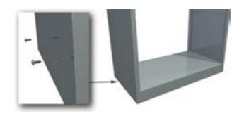
4. Положить изделие на горизонтальную поверхность передней частью вниз. Соединить боковые стенки с дном с помощью четырех винтов М5х16. После этого вернуть изделие в вертикальное положение.
