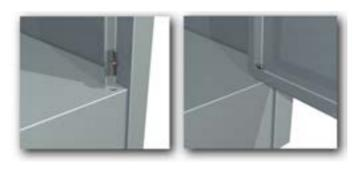
11. На верхнюю плоскость двери положить шайбу. Удерживая шайбу, верхнюю плоскость двери завести под кронштейн полки. Совместив соответствующие отверстия в двери и кронштейне, вставить ось. Аналогичным образом установить двери второго и третьего яруса.
