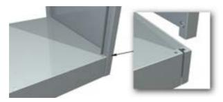
2. Прикрепить боковую стенку к дну двумя саморезами. Для облегчения сборки рекомендуется лишь слегка "наживить" саморезы, не затягивая до конца (либо вообще не устанавливать), а окончательную затяжку произвести после выполнения пункта 4 настоящей инструкции.
